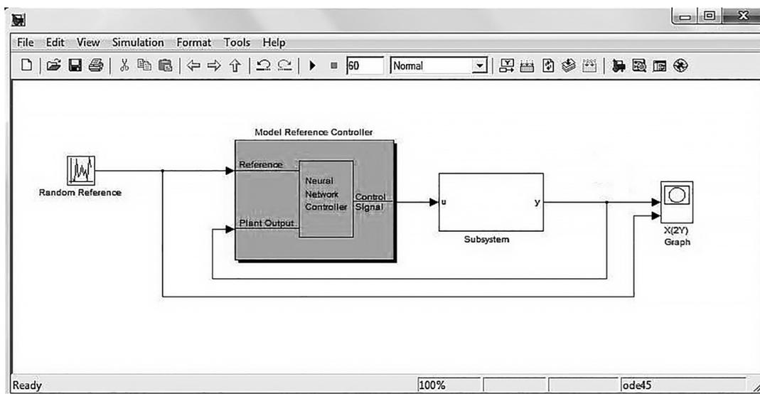
Рис. 5. Принципиальная схема моделирования в обозначениях системы Matlab/Simulink.
